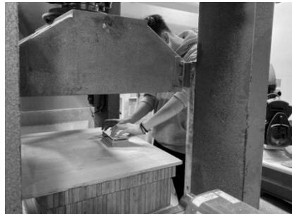
圖 8 液壓機壓合
